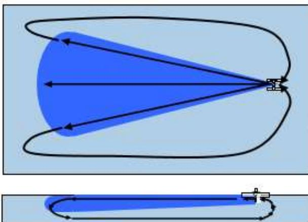
In Folge der impulsartigen Strömung in circa 30° Winkel vom OLOID in eine Richtung bildet sich eine herzähnliche Strömung im Tank aus, welche das gesamte Volumen der Emulsion erfasst und vermischt. Dadurch wird der Trennungsvorgang der beiden Medien (Wasser und Schmierstoff) bei Stillstand verhindert. Diese Strömungsverhältnisse sind im linken Bild schematisch zu sehen.
